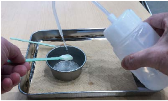
①クリーニングスティックに 洗浄液を十分に浸す
