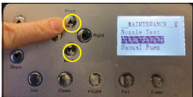
①メンテナンスメニューで上下キーを押し、 Nozzle Test をハイライトする。
