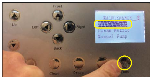
②[Enter] キーを押して、 Nozzle Test を実行する。
